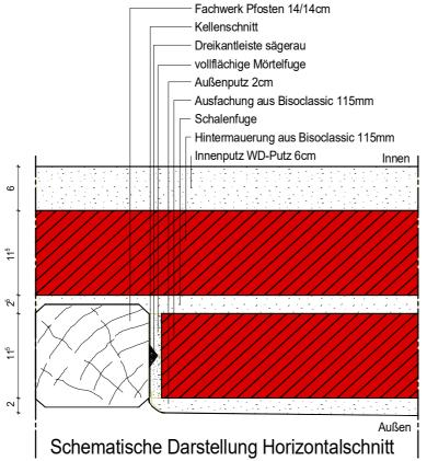
Die Darstellung zeigt einen mehrschaligen Fachwerkaufbau. Diese Konstruktion wird gewählt bei ausreichend großem Innenraum und bei Anforderung nach einem sehr guten Wärmeschutz.
